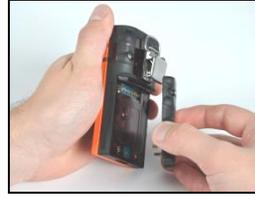
Para instalar la batería, alinéela con el instrumento.
