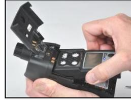
Coloque el instrumento en la caja de la bomba; apriete\* los cuatro tornillos Torx en la parte trasera de la bomba.
