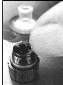
Inserte el filtro de reemplazo en la tapa del filtro (se muestra el filtro N/P 17058157).
