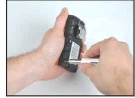
Use un destornillador Torx para apretar\* cada uno de los cuatro tornillos a fin de fijar la batería (mostrada) o la cubierta de la batería al instrumento.
