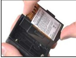
Para instalar la batería de larga duración, coloque primero la batería en la cubierta de la batería. Cuando se coloque correctamente, se mostrará la etiqueta de la batería.
