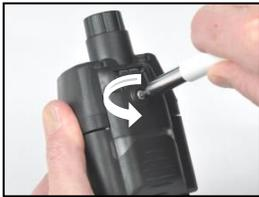
Afloje el tornillo de la puerta de la bomba. Deslice la puerta de la bomba hacia abajo; levántela para abrirla.
