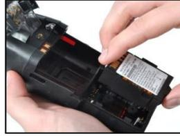
Instale una batería de larga duración compatible, con la etiqueta apuntando hacia arriba, en el receptáculo inferior de la caja de la bomba.
