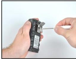
Para quitar la presilla, use un destornillador Torx para aflojar el tornillo de la presilla. Gire hacia la izquierda para aflojarlo.
