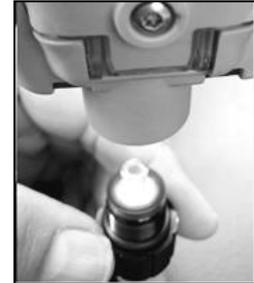
Invierta el instrumento. Coloque el filtro interno nuevo en el cilindro de entrada del módulo de la bomba.
